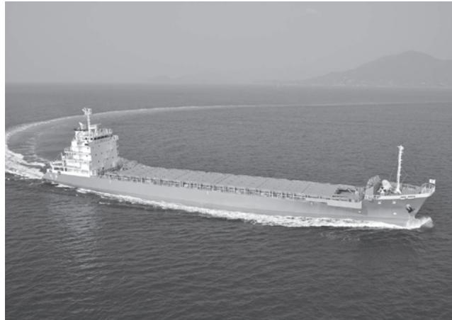
丸三海運(株)殿の主要航路である大阪⇄那覇に投入される最新鋭の高速コンテナ船です。コンテナ搭載個数は同社船では248TEUと最大級となり、沖縄圏と関西圏の生活物資や物流そのものを支えます。そして将来の内航海運が抱える船員問題にも優しく対応するために高度船舶安全管理システムで24時間監視を行ない主機異常の早期発見ならびに重大事故の予防保全が計られています。
