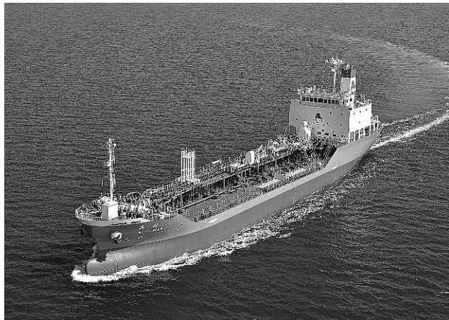
本船は5,310馬力（3900kW×210min<sup>-1</sup>）の2サイクルディーゼルエンジン（6L35MC）を出力軽減（ディレーティング）して3,600馬力（2640kW×178min<sup>-1</sup>）で使用することで、燃費を向上しております。
