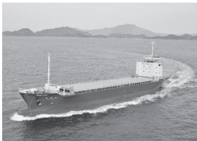
本船は749G/T貨物船として徳山湾内の石炭輸送に従事し、湾内の石炭海上輸送における大きな役割を担われております。湾内航海中は比較的低負荷域での航行が予想される事から、空気冷却器に過冷防止用の温調弁を追加、また離着岸時にA重油に切り替えずにC重油まま発停出来るP-Pシステム(技術ニュースNo.48記載)を採用されております。
