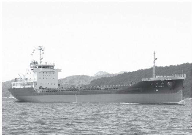
新造船「みらい」は石灰石等を運搬する6000D/Wの貨物船です。特徴は貨物艙隔壁材および内底材にJFEスチールの石炭運搬船カーゴホールド用の耐食性鋼板を採用し貨物艙鋼板の耐用年数を25年とする長寿命化とメンテナンスコストの削減を可能としました。
