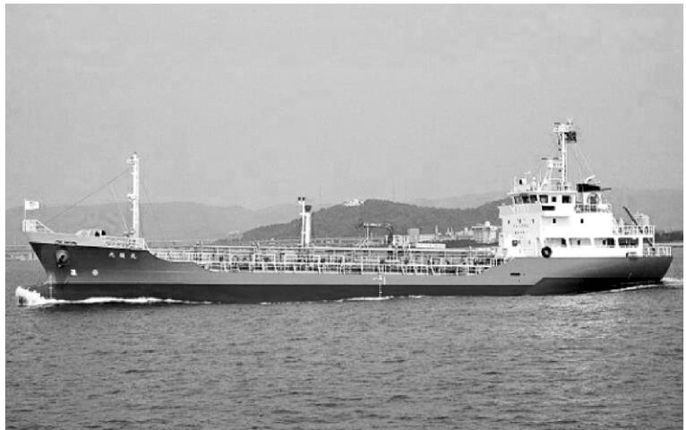
本船は濃硫酸を主要貨物とするケミカルタンカーです。従来の濃硫酸運搬船では貨物タンクの材質を鉄鋼板としていましたが、本船は輸送時における積荷の品質保持を目的にステンレス(SUS316L)材へグレードアップされています。
