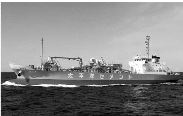
本船は735G/T総トン型のセメント運搬船で、二層甲板の2,000ton積です。主機関は低騒音、低振動で好評な油圧動弁方式の吸排気弁を採用したLAシリーズのLA34G形を搭載しております。他の特徴としては、特殊舵・バウスラスター・NHVプロペラ・フレンドフィンが装備されています。航路は津久見～荻田ほか国内一円で、本船竣工の4ヶ月後には同型船として「海門丸」が竣工されました。
