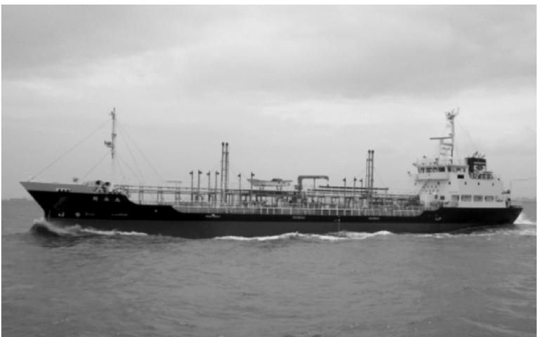
本船は930G/T総トン型の黒油タンカーです。主機関は低騒音、低振動で好評な油圧動弁方式の吸排気弁を採用したLAシリーズでは最新のLA32G形主機関の初号機です。航路は秋田～新潟～大分が主要航路となっています。時には、日本で僅かしか産出出来ない原油を運ぶ事もあります。季節により、気象条件が非常に厳しくなる日本海ですが、乗組員の方々の居住性にも十分配慮された船舶となっております。
