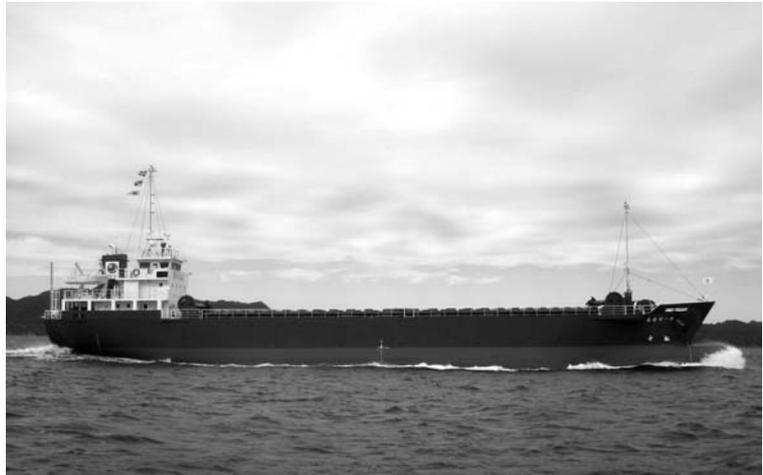
山中造船株式会社殿が特許(特許第2841171号)を取得されているエラ船型を採用した船で、同じ貨物艙寸法を持つ従来船型に比べ船体抵抗が低減し約10%の省エネ効果を得ています。主要貨物は鋼材で、水島(岡山県)を拠点に仙台、名古屋地区が主な航路となっています。
