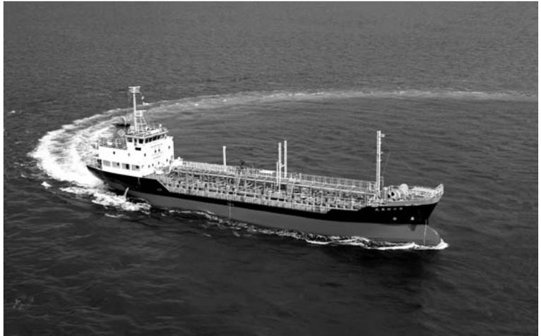
749総トン型のケミカルタンカーで、主機関は新形低速4サイクルLA28G形機関を搭載しています。LA28G形機関は油圧駆動方式吸排気弁を採用し、主機関からの振動・騒音を低減しております。また、同グループの貨物船「新つがる丸」(LA34形主機関搭載、2003年7月建造)と同様、最新鋭航海支援システムに併せて、エンジン監視と船舶運航支援システム「ハナシスBタイプ」が採用され、機関の適正保全と乗組員の労力削減に大きく寄与しています。
