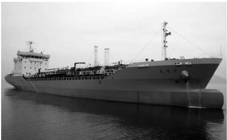
本船はコスモ海運(株)殿の社船として初めて建造された6000 $kl$ 積型となっており、高度船舶安全管理システム(HANASYS-EXPERT)を採用していただいております。白油と石化製品が積めるIMOタイプ 型で、コンタミ(製品混入)防止と荷揚げ迅速化のため、ディーブウェルポンプをタンク毎に装備した近代化船です。
