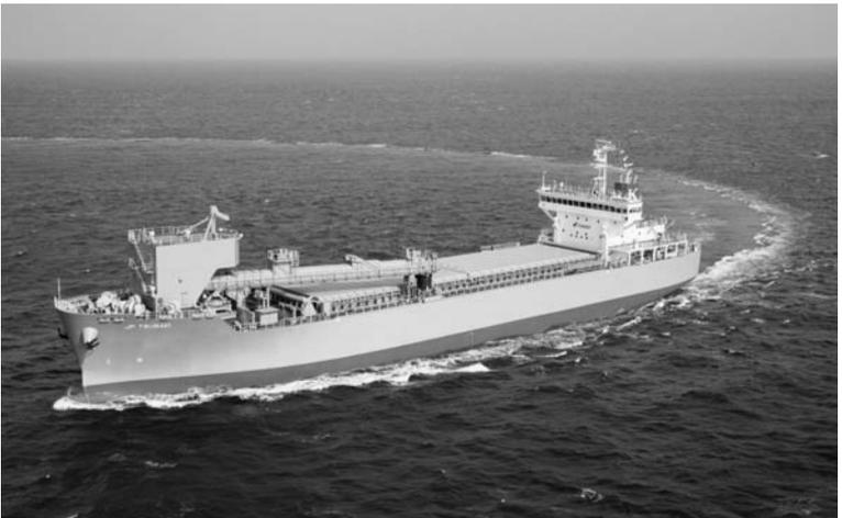
Self Unloader(SUL)荷役装置を装備した6000トン積型石炭運搬船です。SUL荷役装置を総合制御室にて遠隔操作し、粉塵を出すことなく毎時1500トンの石炭を揚荷することを可能としていると共に、ベクソインラダー、及びバウスラスタによるジョイスティックコントロール等、随所に高度な技術を取り入れることにより、操船性の向上と人員の省力化を図った設計がなされています。また、環境問題が重要視されている昨今ですが、A重油を専焼することによりNOx、SOxを抑え、クリーンな運航も実現しております。
